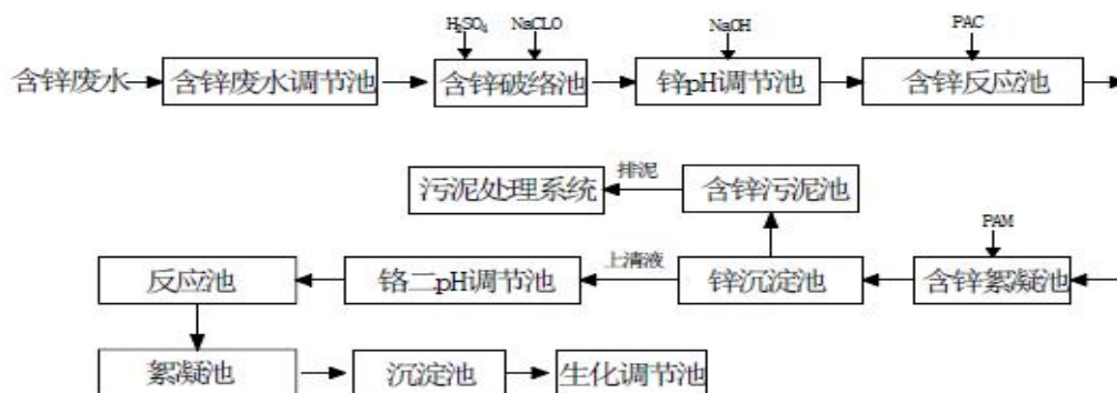
图 3.3.2-6 含锌废水预处理工艺流程图
